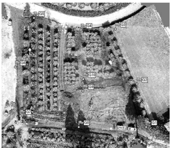
但し、通常のドローンは単独測位のデータ（特に高度の誤差は大）なので写真測量の精度を上げるために地上に対空標識を設置して位置調整を行わなければなりません。このシステムを使えば改善できるのではないかと取り組んだ次第です。
