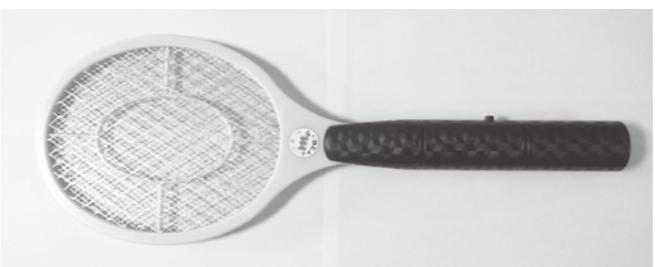
横のボタンを押している間、電流が流れる仕組みです。
